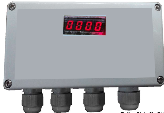
Tr.No.-16,17,18 110/220 VAC Gland-1 Tr.No.-10,11,12, 13,14,15, Relay O/P Gland-2 Tr.No.-8(+),9(-) 4-20mA Gland-3 Tr.No.-5(+), 6L, 7(-) I/P Gland-4
